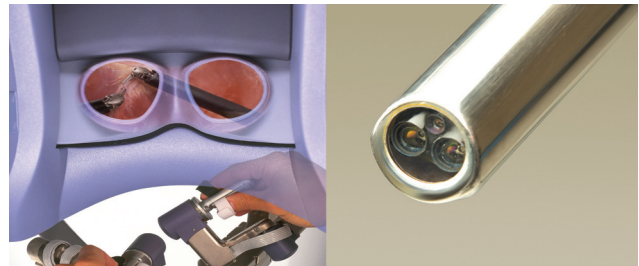
Şekil 2 Robotik konsoldaki üç boyutlu görüntü ve robotik kolların yönetildiği kumanda sahası (sol) ile binoküler optik (sağ).
